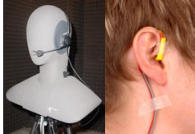
2.13. ábra: A zajszint mérése a fülhöz HATS és MIRE módszer használatával. Fényképezte és rendelkezésre bocsátotta: Health and Safety Executive (Egészségügyi és biztonsági igazgató) – Nagy-Britannia. Bal: Fej és torzó szimulátor (forrás: HEAD Acoustics GmbH, Németország) Jobb: MIRE
