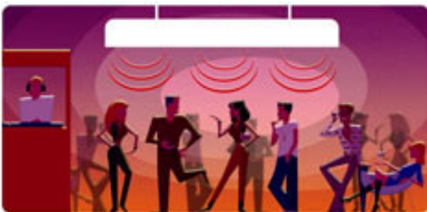
8.1. ábra: Diszkó a két fő hangfal helyett több hangszórót tartalmazó akusztikus mennyezettel
