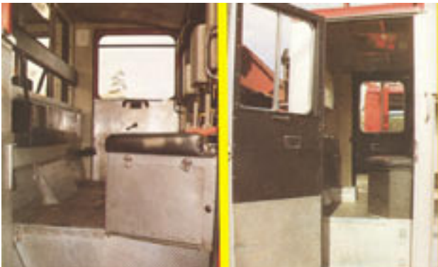
4.16. ábra: Közlekedés – Ebben a személyszállító közúti járműben a zajt a padlón és az oldalfalakon elhelyezett acélborítású üveggappával és az egyéb felületeken hangelnyelő anyagokkal csökkentették. © Health & Safety Executive (Egészségügyi és biztonsági igazgató) – Egyesült Királyság.
