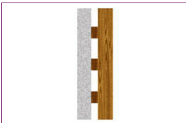
3.7. ábra: A „membránok” tartóléc fölé, a falra rögzített falemezek. Alacsony frekvenciájú hangokat csillapítanak.
