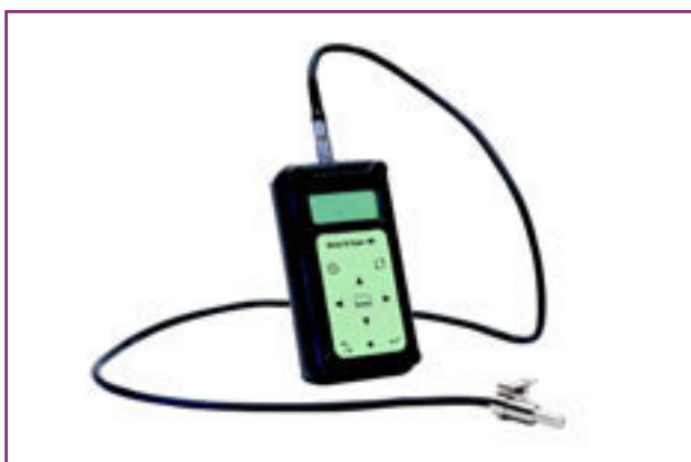
2.6. ábra: Dózismérő Fényképezte és rendelkezésre bocsátotta: Brüel & Kjaer
