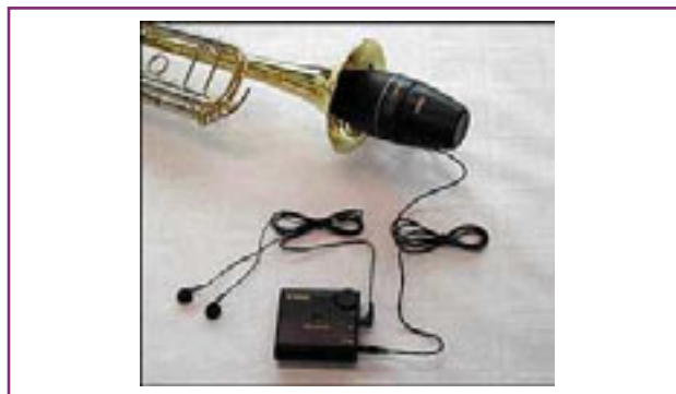
8.4. ábra: Hangerőszabályozó rendszer rézfúvósoknak Fotó: © Yamaha Music
