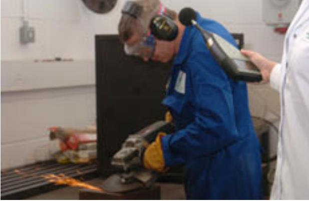
2.11. ábra: A zajszint mérése egy kezelő fülénél. Fényképezte és rendelkezésre bocsátotta: Health and Safety Executive (Egészségügyi és biztonsági igazgató) – Nagy-Britannia.
